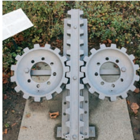
Зъбчатата жп система, разработена от Лохер
