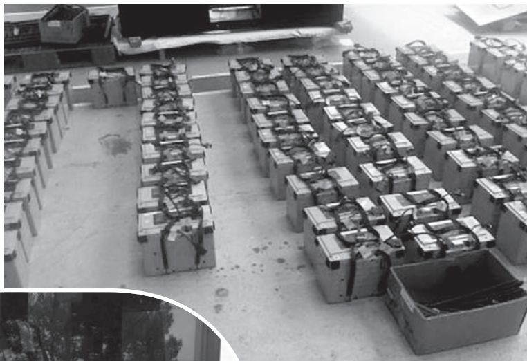
Опитният състав е снабден с американски литиево-метал-магнезиево-фосфатни акумулаторни батерии
