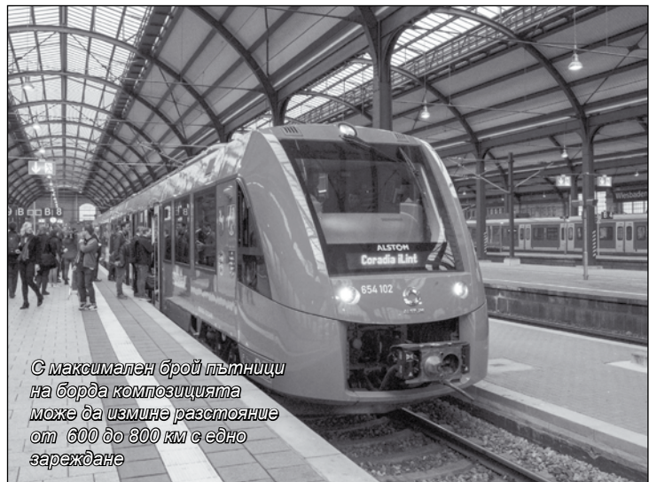
На покрива на вагоните са монтирани резервоари с водород, които захранват горивните клетки, произвеждащи електрическата енергия
