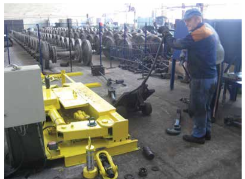
След като си преминал през специализираното обучение, работата със стенда за монтаж на лагери не изглежда трудна.
